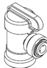
9°) - La vanne du réservoir
