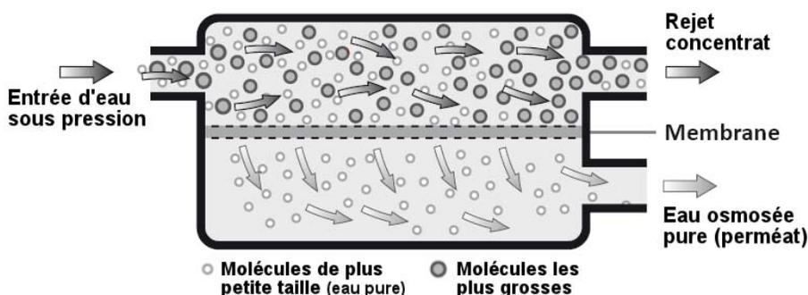
Seules les molécules d'eau, les plus petites en taille, peuvent traverser la membrane d'osmose semi-perméable. Toutes les molécules de taille supérieure à 0,1 nanomètre sont rejetées.
