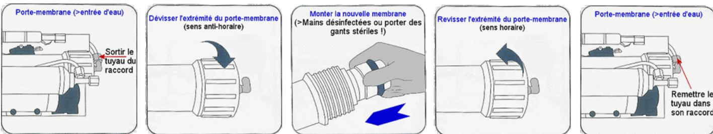
1. Sortir le tuyau d'arrivée d'eau de son raccord en entrée du porte membrane.
