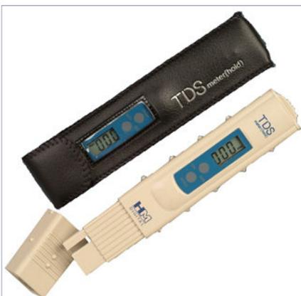
Un conductimètre permet de **mesurer la conductivité** de l'eau osmosée produite. Cette conductivité est liée à la quantité de minéraux dissous. Sachant qu'une eau parfaitement osmosée ne contient quasiment plus de minéraux, sa conductivité doit être très basse, de l'ordre de 10 à 15ppm. Plus la conductivité augmente, moins l'eau osmosée est de bonne qualité car elle contient encore des minéraux dissous.
