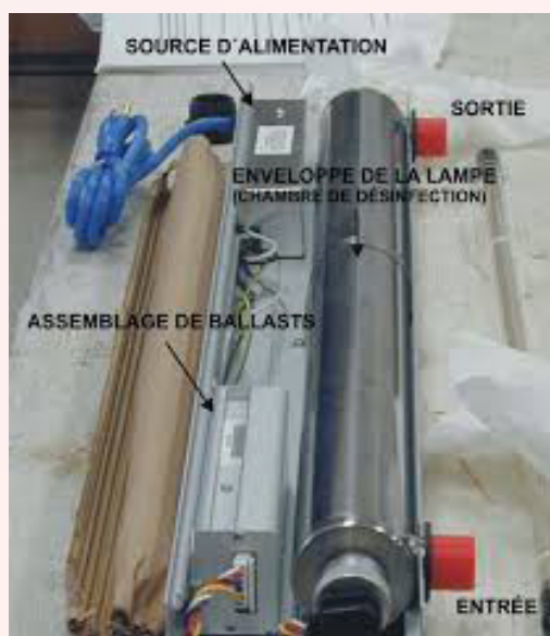
Figure 3: Exemple d'appareil de traitement UV avec son capot enlevé
