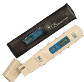
Un conductimètre ou TDS-mètre permet de **mesurer la conductivité** de l'eau osmosée produite. Cette conductivité est liée à la quantité de minéraux dissous. Sachant qu'une eau parfaitement osmosée ne contient quasiment plus de minéraux, sa conductivité doit être très basse, de l'ordre de 10 à 15ppm. Plus la conductivité augmente, moins l'eau osmosée est de bonne qualité car elle contient encore des minéraux dissous.
